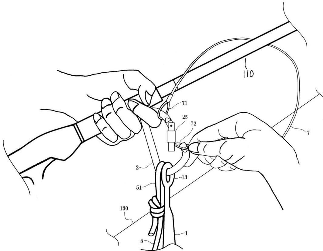
＜図 8 は、リールが大きくて、ループ体 (7) がリールを越えられない場合に行う、巻き付け方式を示す＞竿を持つ手の人差し指にカラビナ (2) を掛け、リールの前側で巻き体 (7) として、道糸 (130) ごと竿 (110) に巻いてやり、他端の小ループ部 (72) をカラビナ (2) に掛け、安全環 (25) を回し、ロックする (竿を立てたまま、片手で可能)。これにより、図 4 に近似の状態になる。
